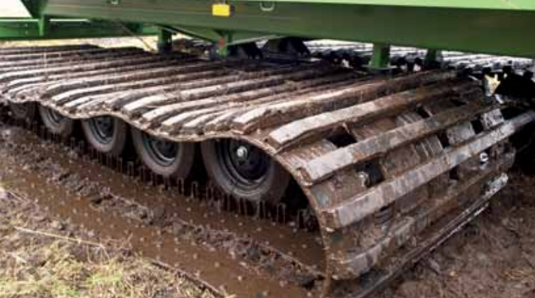
Gąsienice z nakładkami wymiennymi gumowymi
