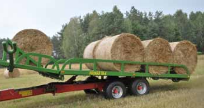
Prosty system rozmieszczenia bel na platformie ładunkowej
