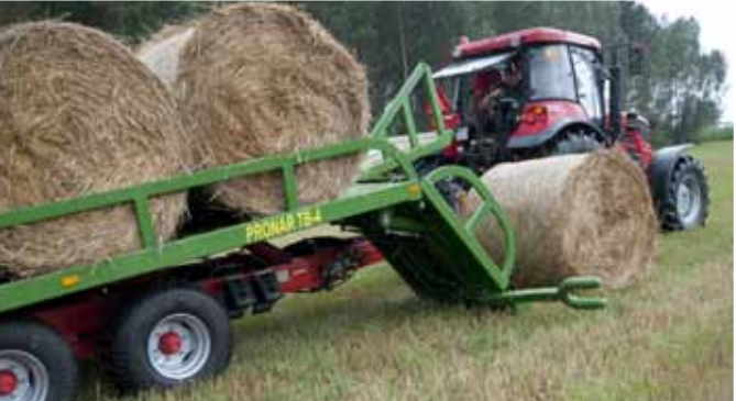
Prosty system rozmieszczenia bel na platformie ładunkowej
